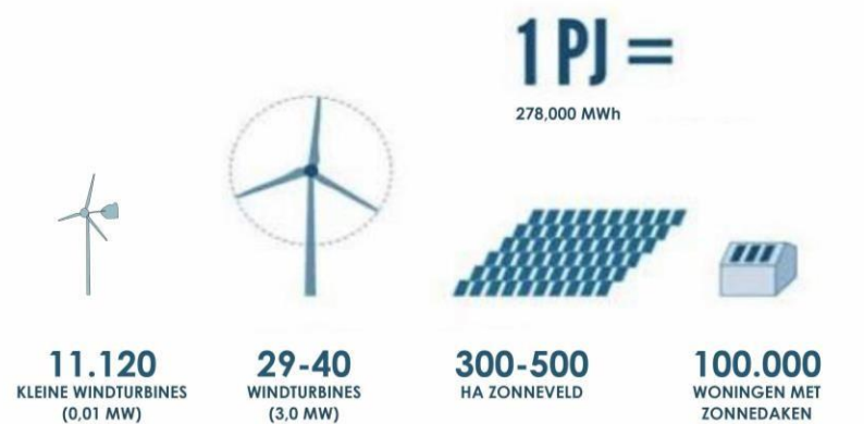
Figuur 7.3: Energieopbrengst van hernieuwbare energiebronnen: KWT in verhouding met grote turbines en zonnepanelen
